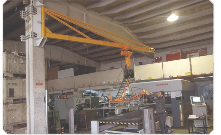
MEVCUT KOLONA MONTAJ PERGEL VİNÇTE VAKUMLA SAC TAŞIMA
