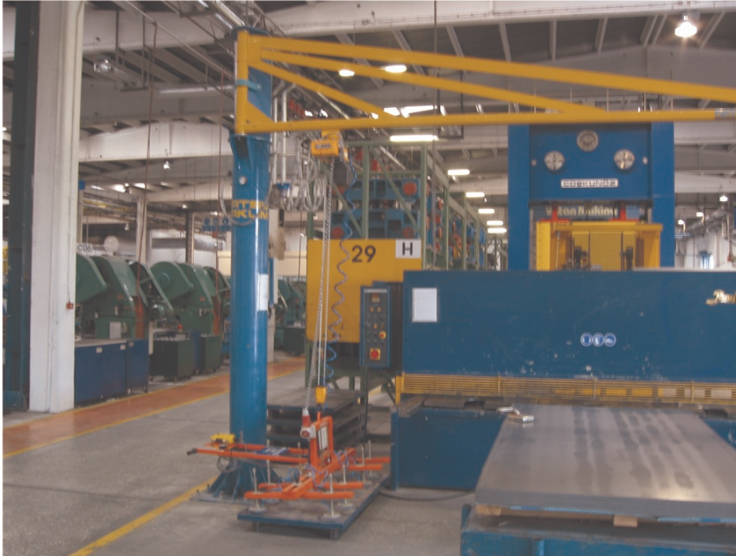
SABİT DİREKLİ PERGEL VİNÇTE VAKUMLA SAC TAŞIMA
