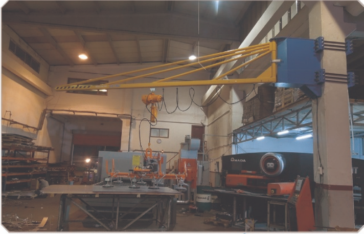
MEVCUT KOLONA MONTAJ PERGEL VİNÇTE VAKUMLA SAC TAŞIMA
