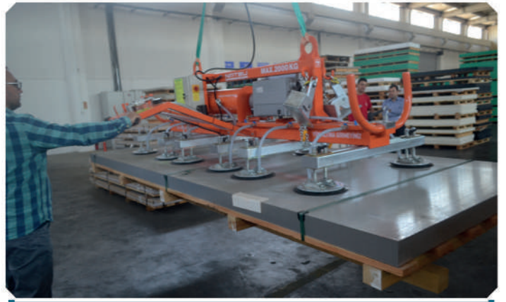
ALÜMİNYUM BLOKLARIN VAKUMLA TAŞINMASI
