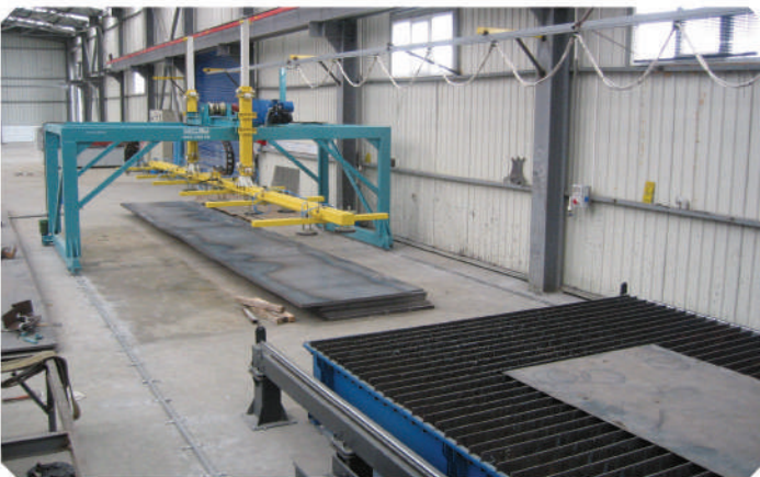
PLAZMA TEZGAHINA OTOMATİK VAKUMSAC İLE YÜKLEME
