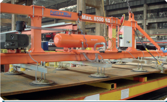
BÜYÜK SAÇLARIN VAKUMLA TAŞINMASI 8.500 KG
