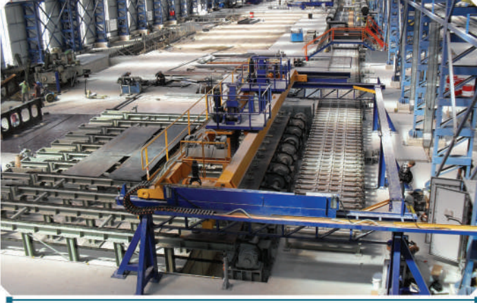
12x3 M. 3 TON SACLARIN OTOMATİK BESLENMESİ
