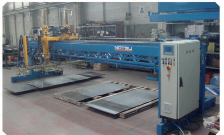
OTOMATİK VAKUMSAC İLE PASLANMAZ SAC KALİTE KONTROL
