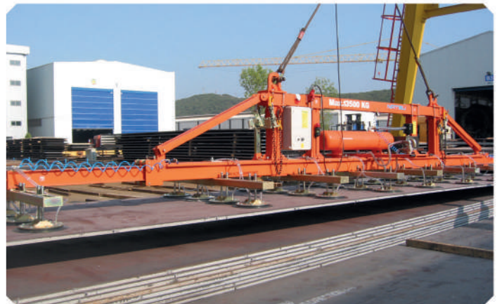
PORTAL VİNÇTE 13,5 TON 14 M. UZUNLUĞUNDA SAC KALDIRMA
