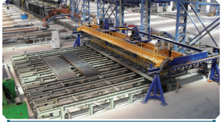
HADDE FIRINI OTOMATİK SAC BESLEME 7,5 TON
