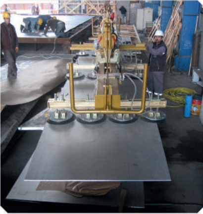
PLAZMAYA VAKUMSAC İLE YÜKLEME
