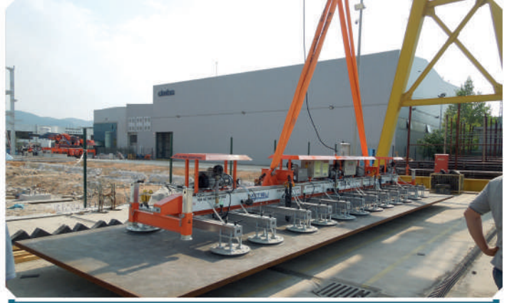
BÜYÜK SAÇLARIN VAKUMLA TAŞINMASI 16.500 KG
