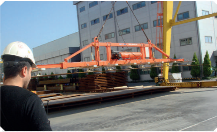
BÜYÜK SAÇLARIN VAKUMLA TAŞINMASI 8.500 KG
