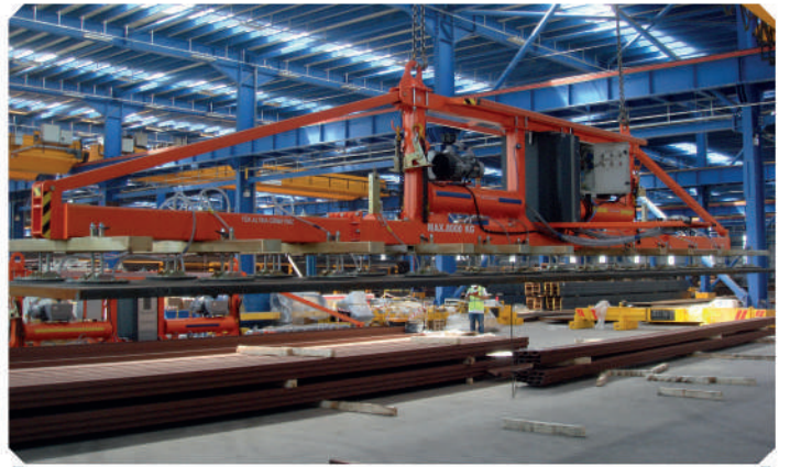
BÜYÜK SAÇLARIN VAKUMLA TAŞINMASI 16.500 KG
