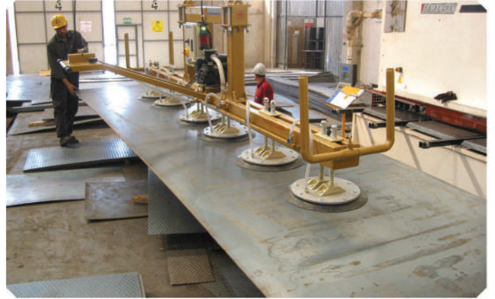
TEK SIRALI VAKUMSAC İLE KALDIRMA
