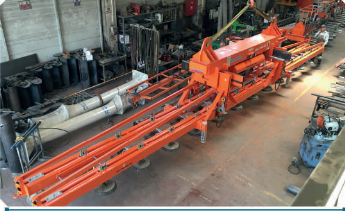
MOTORLU-GENİŞLİĞİ AYARLANABİLİR VAKUMLA SAC TAŞIMA
