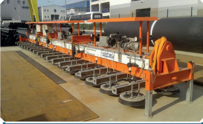
22.500 KG SAÇLARIN VAKUMLA TAŞINMASI
